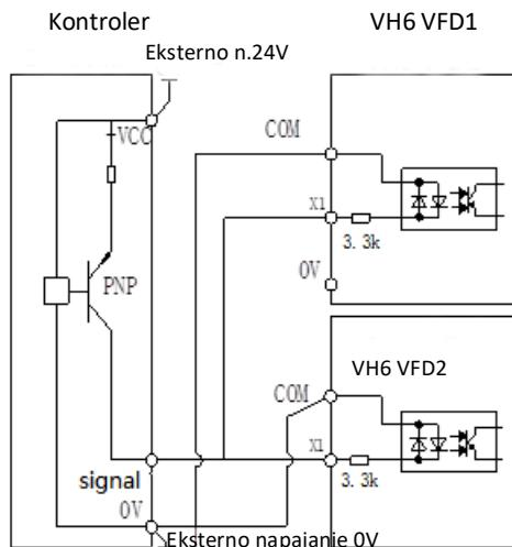
Ožičenje više VFD sa eksternim napajanjem 24V
