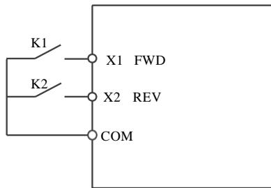
Kao što je prikazano na gornjem dijagramu, kada je K1 zatvoren, rad frekventnog regulatora je u forward smeru. Kada je K2 zatvoren, frekventni regulator radi tako da se motor obrće u reverse smeru. Kada su K1 i K2 istovremeno zatvoreni ili otvoreni, frekventni regulator prestaje sa radom.
