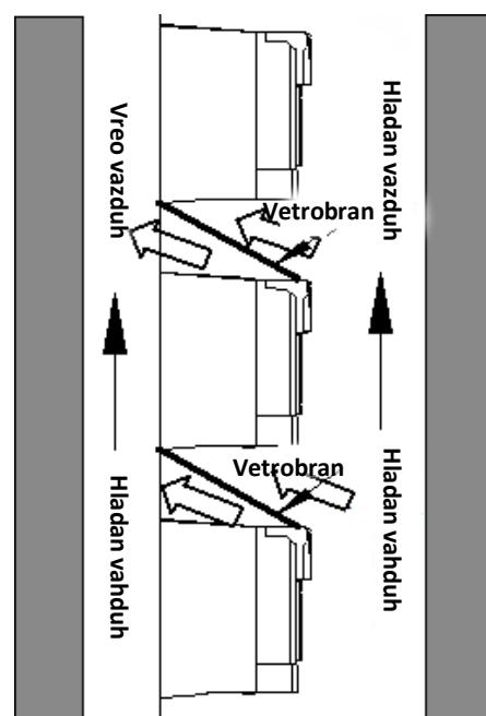
Napomena: Prilikom vertikalne instalacije, mora se dodati vetrobran, inače će dolaziti do međusobnog uticaja više frekventnih regulatora što će dovesti do slabe disipacije topote.
