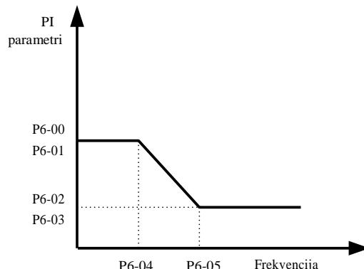
Dinamičke karakteristike petlje brzina u režimu vektorske kontrole se mogu podešavati postavljanjem vrednosti proporcionalnog koeficijenta pojačanja i integralnog vremena kontrolera brzine. Da biste postigli brži odgovor sistema, povećajte vrednost proporcionalnog koeficijenta pojačanja i smanjite integralno vreme. Treba uzeti u obzir da ovo može dovesti do oscilacija u sistemu i njegove nestabilnosti. Preporučeni metod podešavanja:
