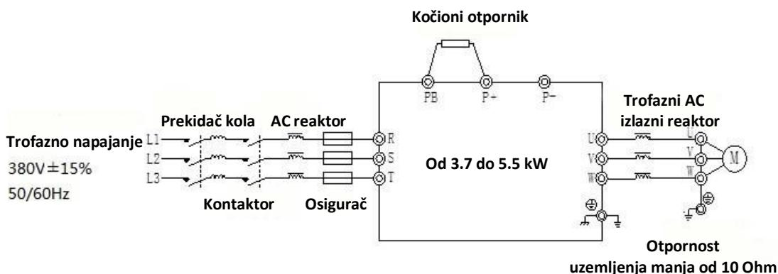
Napomena: Prekidač kola, kontaktor, AC reaktor, osigurač, kočioni otpornik i izlazni reaktor su opcioni delovi.
