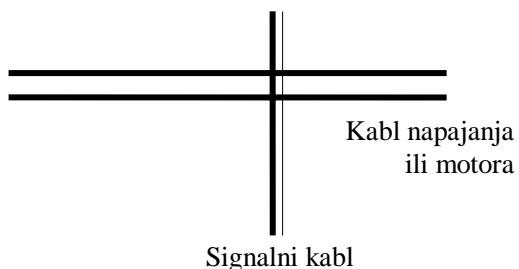
6. Visoko-strujna kola se moraju uzemljiti posebno od nisko-strujnih i signalnih kola.
