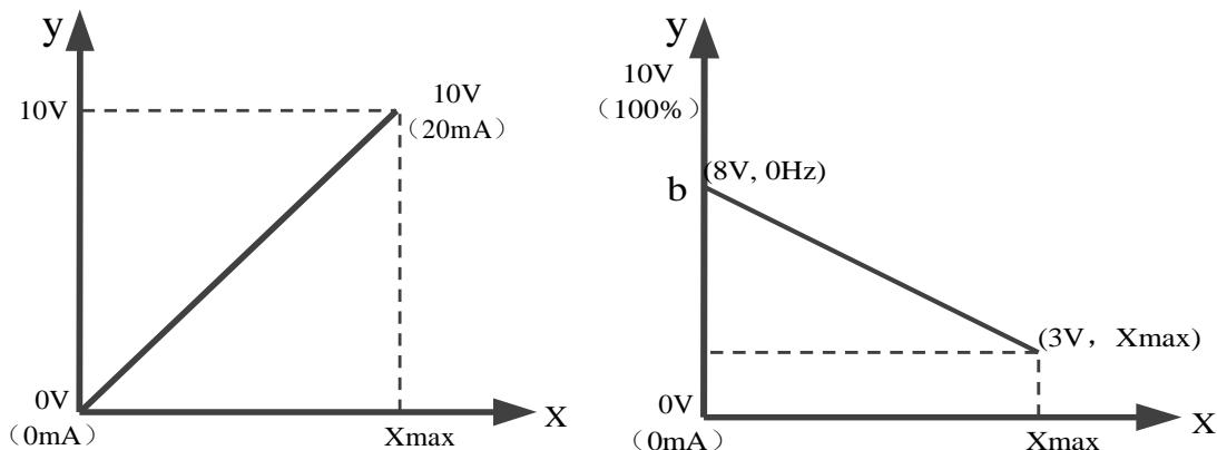
$$\text{Koeficijent offseta nule} = \frac{\text{Izlaz pri } 0\text{Hz}}{\text{max izlaz}} \times 100\%$$
