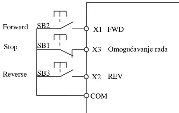
SB1: Dugme stop (kontakti zatvoreni, omogućen start frekventnog regulatora). SB2: Dugme za forward rad (NO) kratko pritisnuti. SB3: Dugme za reverse rad (NO) kratko pritisnuti. U ovom modu kontrole, ulaz X3 je ulaz za isključivanje, a ulazi X1 i X2 su za uključivanje frekventnog regulatora.
