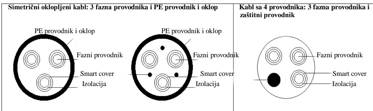
Napomena: ako je provodljivost oklopa kabla motora ne zadovoljava zahteva, potrebno je koristiti poseban PE provodnik.
