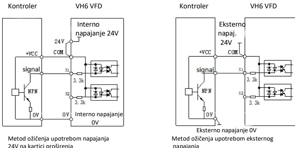
Najčešći način ožičenja je prikazan na ilustraciji levo za frekventni regulator sa internim napajanjem od 24V. COM terminal frekventnog regulatora se kratko spaja sa terminalom napajanja 24V, a terminal 0V frekventnog regulatora se povezuje sa terminalom 0V eksternog kontrolera.
