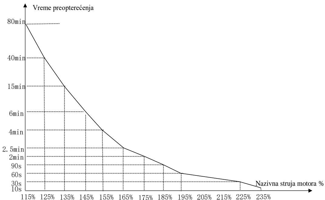
(1) Kada radna struja motora dostigne 175% nizivne struje motora, biće prijavljeno preopterećenje motora (Err10) nakon neprekidnog rada u trajanju od 2 minuta; kada radna struja motora dostigne 115% nizivne struje motora, biće prijavljeno preopterećenje motora (Err10) nakon neprekidnog rada u trajanju od 80 minuta.
