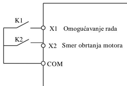
Kao što je prikazano na gornjem dijagramu, u ovom kontrolnom modu kada je K1 zatvoren, K2 se otvara i motor rotira forward; kada se K2 zatvori, motor se okreće u obrnutom smeru; kada se K1 otvorí frekventni regulator prestaje sa radom.
