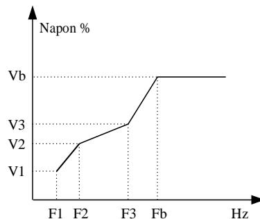
Napomena:  $V_1 \sim V_3$ : procenti napona u delovima 1 ~ 3 VF krive sa više tačaka.  $F_1 \sim F_3$ : frekvencije u delovima 1 ~ 3 VF krive sa više tačaka.
