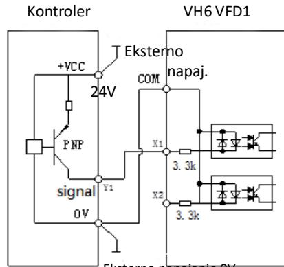
Metod ožičenja jednog VFD upotreboom eksternog napajanja 24V
