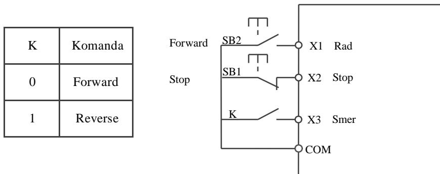
SB1: Dugme za zaustavljanje rada frekventnog regulatora. SB2: Dugme za početak rada. U ovom režimu, X2 je ulaz za isključivanje, X1 je ulaz za pokretanje rada frekventnog regulatora, a X3 zadaje smer obrtanja motora.
